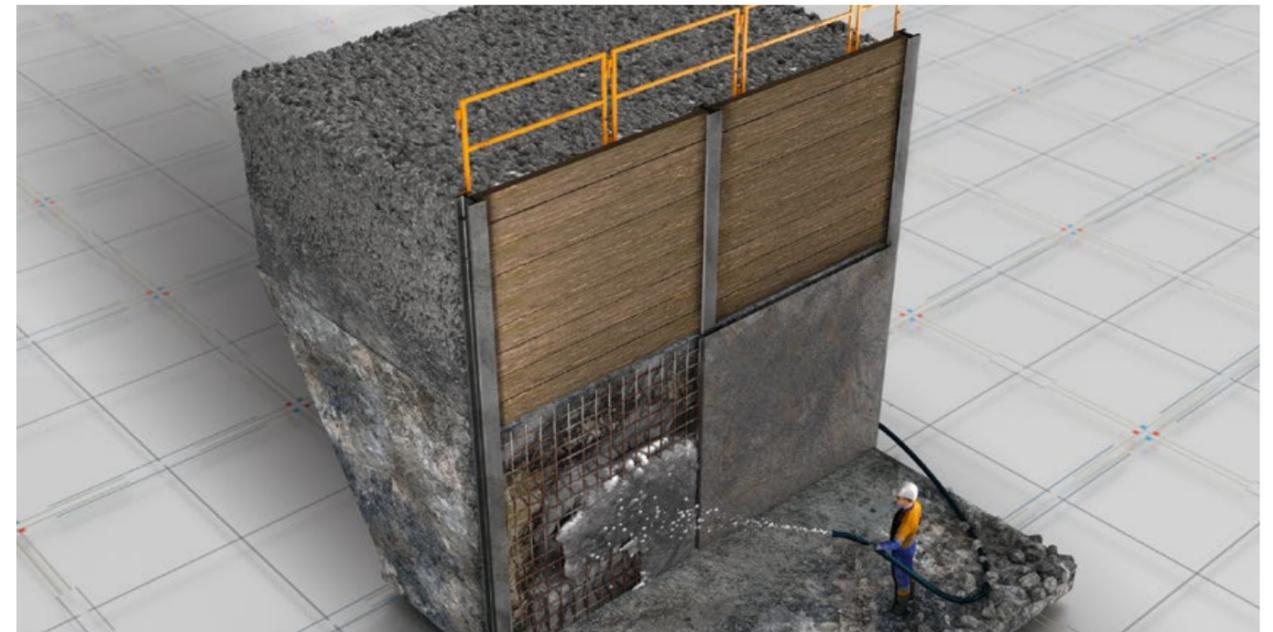
En las pantallas de pilotes discontinuos como son las pantallas tipo *king post*, se instalan pilotes perforados que incorporan elementos estructurales verticales (como perfiles metálicos, jaulas de acero o elementos prefabricados) insertándolos con un espacio mayor entre sí. A continuación, se procede al sostenimiento a través de tablestacas, tabloneros o concreto proyectado que se sitúan entre los elementos estructurales durante las fases sucesivas del proceso de excavación.
