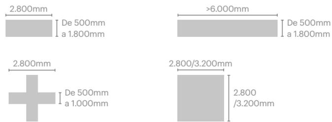
Los barretes se excavan usando cables de perforación montados en grúas, cucharas hidráulicas o una Hidrofresa®\*\*. En cada componente rectangular, el espesor típico se sitúa entre 500 y 2.400mm y la longitud entre 2.200 y 3.600mm. El proceso de excavación empleando cables o cucharas operadas hidráulicamente es muy similar al de los pilotes perforados de gran diámetro construidos con fluido de estabilización.
